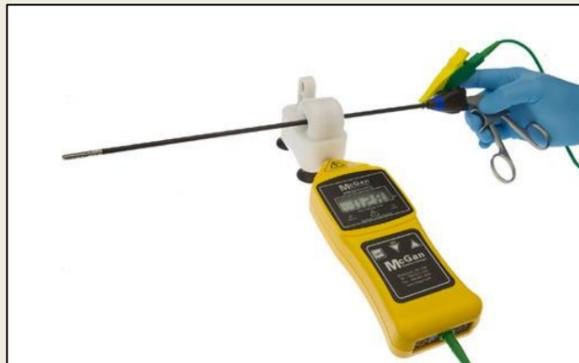
Permet de détecter un trou d'épingle, une fissure ou un point dénudé sur l'instrumentation
